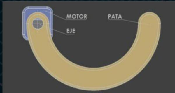
Figura 2: SEMI RUEDA; Como podemos apreciar el eje del motor esta directo al último eslabón del prototipo, Este tipo de configuración o similares ESTAN PROHIBIDAS.
